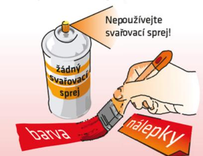
Na dílech nesmí být barevné značení ani nečistoty po svařování, které nejsou rozpustné ve vodě. Tyto nečistoty nelze odstranit mořením a vedou k vadám zinkování.
